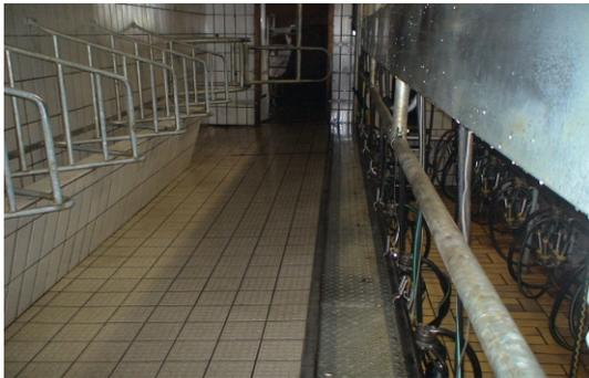
Wie Sie aus den auf diesem Blatt abgedruckten Bildern ersehen können, verfügt die Firma Favorit über ein gut durchdachtes Konzept zur Vergrößerung ihres Melkstandes. Die Abbildungen zeigen einen ehemaligen 2 x 5er Fischgräten-Melkstand. Durch unser Konzept ist daraus ein 2 x 8er Fischgräten-Melkstand geworden. Sehr hilfreich dazu war der freitragende Holmkasten, welcher den meisten Teil der Technik aufnimmt. Ebenso wichtig ist die Z-Kante, welche die Rohrleitungen überbaut.
